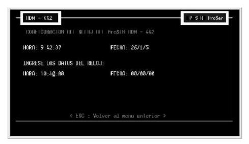
Una vez ingresados los valores, se graban automáticamente (independientemente si guarda o no la configuración al salir del menú de configuración).
