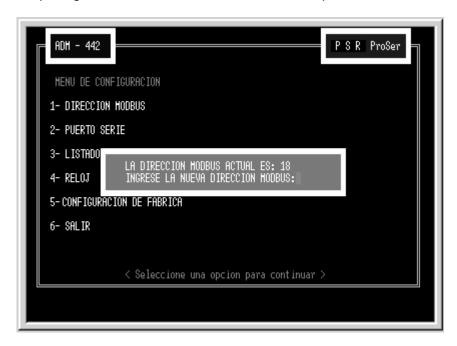
**NOTA:** Para que el ADM-442 PROSER tome como válido el dato, el número ingresado debe ser una dirección modbus válida (1 a 247).
